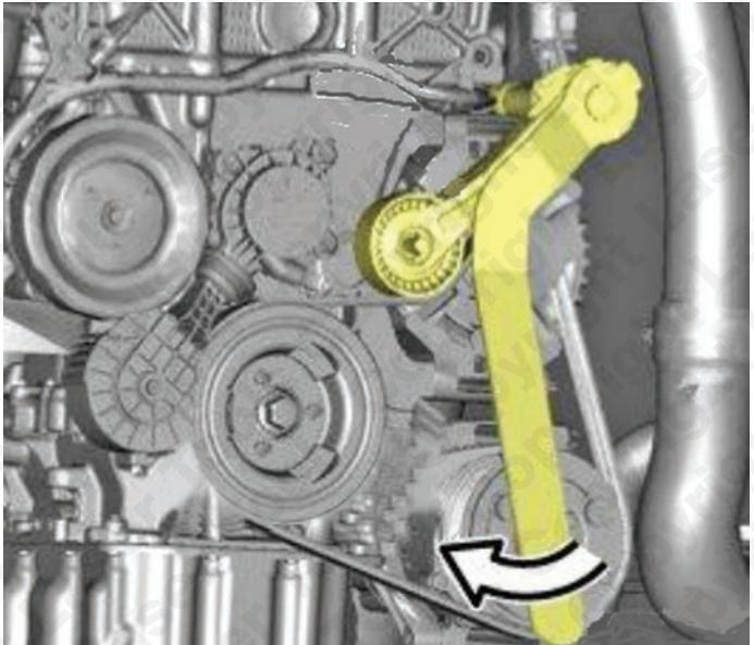
Zugang durch Ausbau des rechten Vorderrads sowie des innerem Radhauses.
