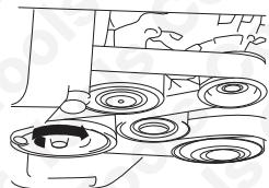
Le pique pour aligner le vilebrequin permet le calage du vilebrequin dans la position de distribution pour les deux types de moteurs. Il peut être nécessaire de tourner le vilebrequin utilisant la poulie verrou central jusqu'au point où les fentes dans l'arbre à cames sont placées horizontalement et le Vilebrequin Épinglé **C** peut être inséré dans la fente dans le vilebrequin correctement, ce peut être nécessaire de tourner le vilebrequin 360°.
