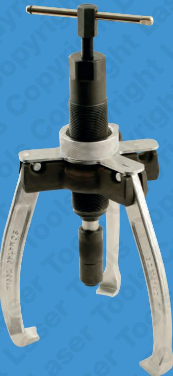
Un estrattore per ingranaggi versatile e ad alta resistenza che utilizza un pistone idraulico per fornire sufficiente forza per rimuovere i cuscinetti, pulegge, ingranaggi, ecc., più difficili da allentare. Può essere utilizzato come estrattore a 2 o 3 bracci ed è facile adattare i bracci (7" / 178 mm) e utilizzarli come presa interna.
