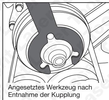
Angesetztes Werkzeug nach Entnahme der Kupplung
