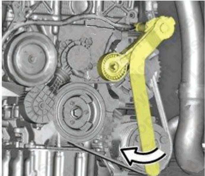
El acceso se consigue mediante la extracción de la rueda delantera derecha y del paso de la rueda interno.
